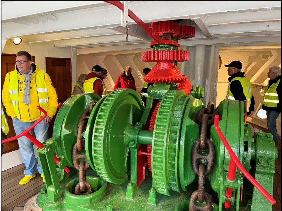
Die Ankerwinde unter Deck.
