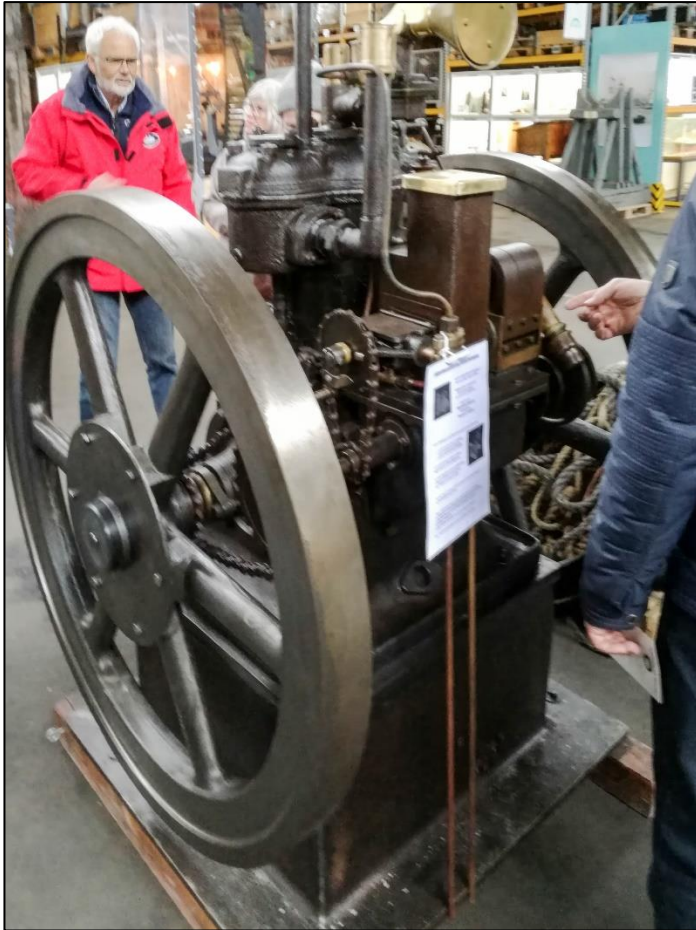
Ein Highlight: Jürgen erklärt uns den Gnom-Windenmotor.(Foto: Elke Dossmann)
